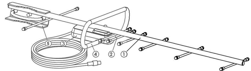
Антенна представляет собой несущую штангу (1), на которой закреплены директоры (2), монтажная коробка (3) с петлевым вибратором (4) (установку производит потребитель см. п.5), усилитель или плата согласования с вмонтированным кабелем. Для установки на мачту антенна имеет узел крепления (5).
