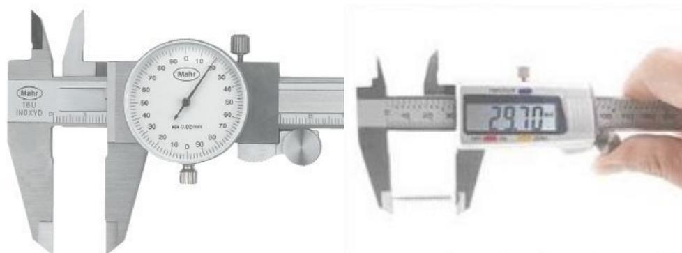
Считать показания со стрелочного прибора достаточно легко. «Целое» значение определяется по основной шкале прибора, количество же десятых или сотых долей указывает стрелка отградуированного циферблата. Затем показания складываются.
