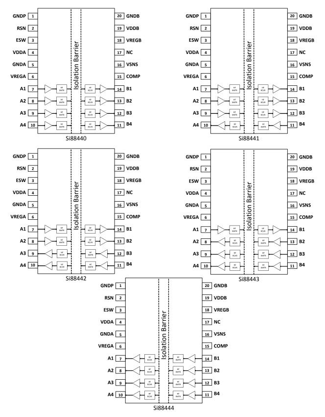
Figure 28. Si8844x Pinout Diagrams
