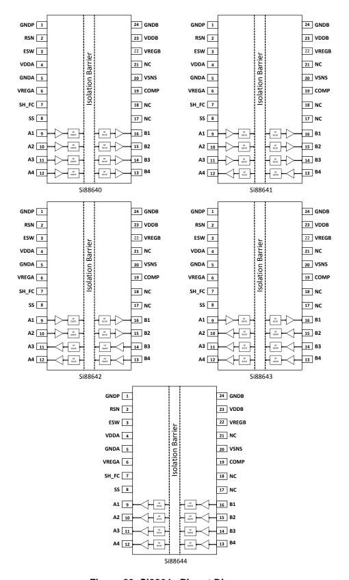
Figure 29. Si8864x Pinout Diagrams
