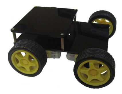
Шасси машинного робота 4-х моторное II с дополнительной плитой. Модель шасси, разработана построения мобильного робота на базе модуля ARDUINO UNO R3 и драйвера мотора ЛМ2-130. В этой модели расширена платформа до 120 мм. размещены установочные отверстия для драйвера и ARDUINO UNO.
