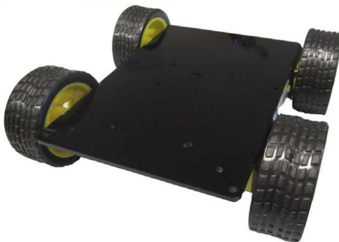
Модель шасси, разработана для установки драйвера электромоторов ЛАПТ и модуля ARDUINO UNO R3.
