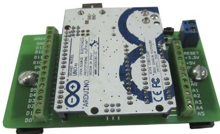
Шильд предназначен для установки контроллера Arduino UNO на DIN рейку. Это дает возможность для использования контроллера Arduino в составе с различными исполнительными устройствами и модулями в системах автоматизации, умный дом, электротехнических системах. Пружинные клеммы упрощают подсоединение сигнальных проводов. Диод Шоттки по питанию предназначен для защиты от переплюсовки, а предохранитель предотвращает повреждение контроллера при превышении напряжения питания выше 24 Вольт.
