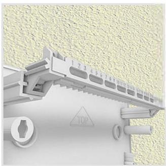
Изолированная шина размещается в пластиковом держателе из самозатухающего материала, выдерживающего температуру нагретой проволоки до 960 °С и теплостойкостью до 120 °С
