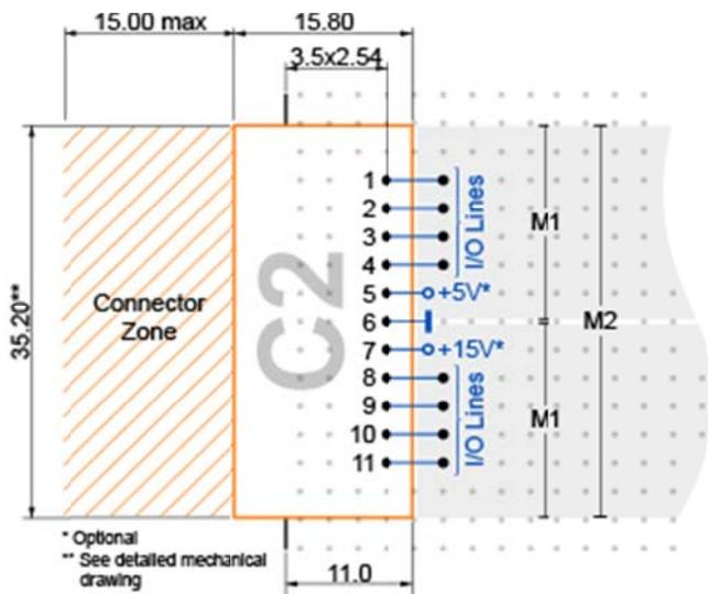
На Плате модули устанавливаются на два посадочных места "С" и внутренними связями устанавливают обмен с соседними "М" тиббитами. C2s имеют такие же ширину и высоту, как и у модулей M2T. Тиббиты C2 всегда оранжевого цвета.
