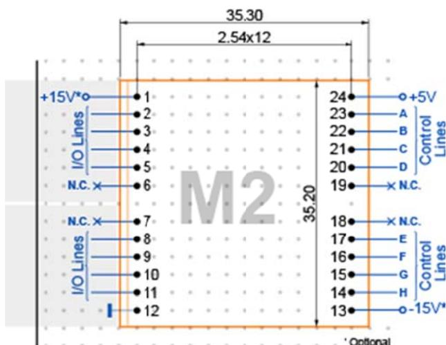
Ножки 14-17 и 20-23 - это линии управления (для подключения к МК) А-Н. Ножки 2-5 и 8-11 - линии ввода/вывода (для внешних коммуникаций). Ножки 12 и 24 - это питание (+5В и "земля"). Ножки 1 и 13 - дополнительное напряжение +/- 15В. Ножки 6, 7, 18 и 19 не используются и должны оставаться не подключенными. Обратите внимание, что отсутствующая ножка в центре тиббита разделяет ряды на 2 группы по 6 пинов.
