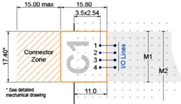
C1 имеют ряд из 4 ножек для коммуникации с "М" тиббитом. Т.е. 4 пина коннектора подключаются ко всем 4 пинам функционального модуля "М1".
