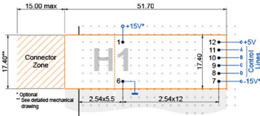
Учитывая особенности конструктива гибридных тиббитов Н1, данные модули не имеют ножек на "секции" С1. В то время, как выводы на секции М1 имеют стандартное расположение и назначение (не считая отсутствия ножек 2-5, которые жестко завязаны конструктивом
