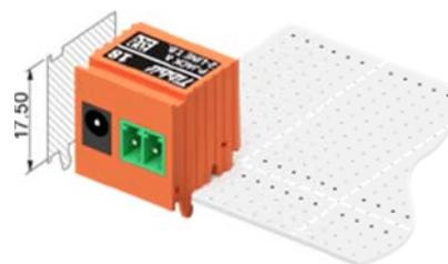
Тиббиты-коннекторы C1 - это просто разъемы питания, клеммы и т.д. Некоторые модификации имеют встроенные датчики (например, датчики температуры, влажности, освещенности и т.д.). Тиббиты C1 всегда оранжевого цвета.
