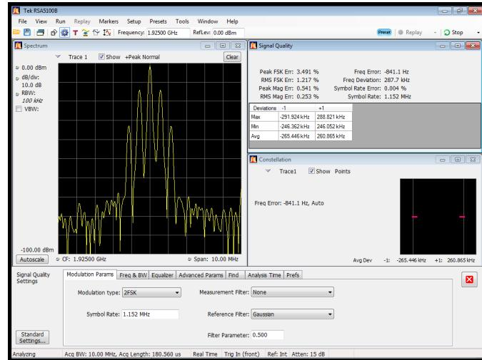
Опция VM06 NADC, ( $\pi/4$  DQPSK, 24,3 кв/б./с, 875 МГц, 0 дБм), ср.кв. значение EVM: 0,3 %
