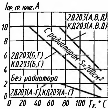
Зависимости допустимого прямого тока от температуры корпуса
