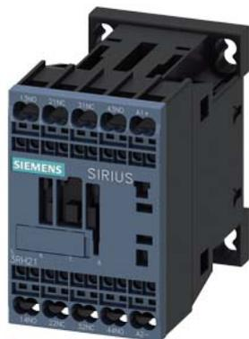
Вспомогательный контактор связи, ж/д 2 НО + 2 НЗ, 110 В DC, 0,7–1,25\* US, с варистором встроено, типоразмер S00, Пружинная клемма
