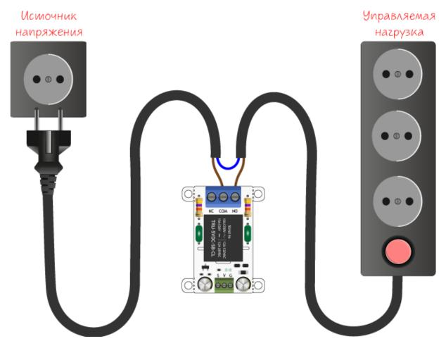
Нагрузка подключена, теперь можно подключать модуль реле к управляющим платформам.
