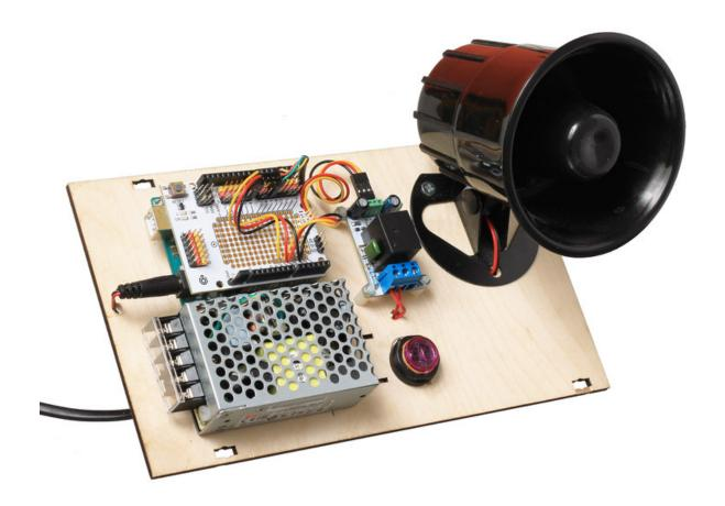
Реле на модуле справиться с током до 15 А и переменным напряжением до 250 В.
