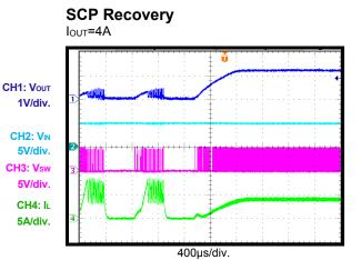
SCP State Iour=4A CH1: Vour 1V/div. CH2: Vin 5V/div. CH3: Vsw 5V/div. CH4: IL 5A/div. CH4: IL 5A/div.
