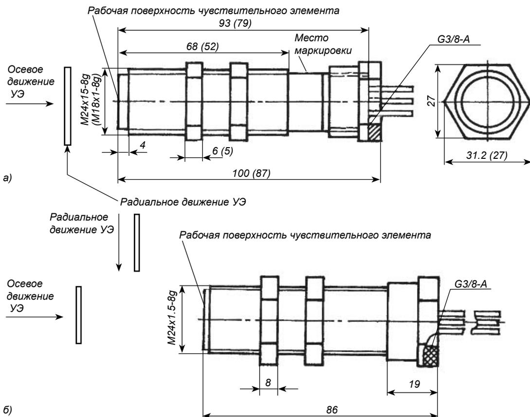
Размеры переключателей с переходной гайкой (с резьбой) для вывода проводов с помощью любых концевых соединений (прямых, угловых):
