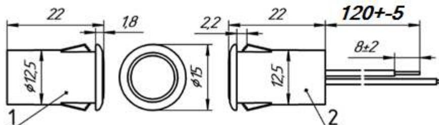
Рис 1. Габаритные и установочные размеры извещателя
