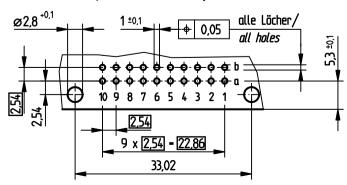
Tauchlötaschluß 0.3 x 0.7 mm / solder terminal 0.3 x 0.7 mm Isolierwerkstaff / hausing material : PBT GF30
