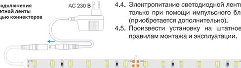
4.4. Электроснабжение светодиодной ленты осуществляется только при помощи импульсного блока питания 24 В (приобретается дополнительно).
