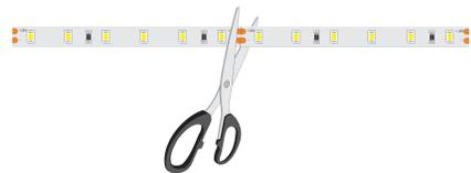
Разрезание ленты производить при выключенном напряжении питания.
