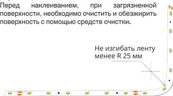
3.11. Наклеивание производить на сухую поверхность.
