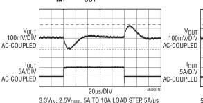
3.3V<sub>IN</sub>, 2.5V<sub>OUT</sub>, 5A TO 10A LOAD STEP, 5A/µs C<sub>OUT</sub> = 1 • 22µF, 6.3V, 1210 + 2 • 100µF 6.3V 1210 CERAMIC CAPACITORS NO CFF CAPACITOR
