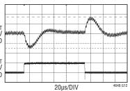
5V<sub>IN</sub>, 3.3V<sub>OUT</sub>, 5A TO 10A LOAD STEP, 5A/ $\mu$ s C<sub>OUT</sub> = 1 • 22 $\mu$ F, 6.3V, 1210 CERAMIC CAPACITORS NO CFF CAPACITOR
