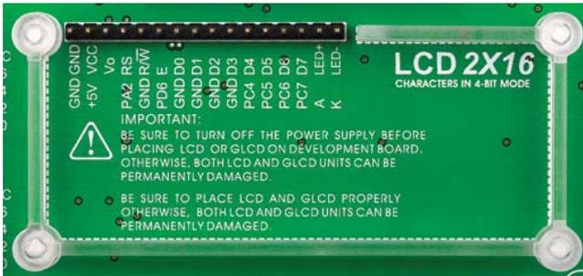
Жидкокристаллические дисплеи или ЖК-дисплеи популярны для конечного пользователя электронного устройства. Плата снабжена разъемом и необходимым интерфейсом для поддержки ЖК-дисплеев 2x16 характеристики. Такой разъем соединен с микроконтроллером через порт **PORTC**. Потенциометр **P4** используется для регулировки
