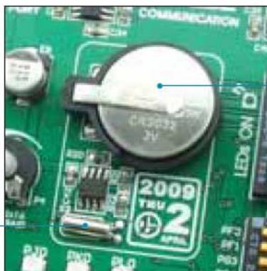
Рисунок 14-1: Модуль часов реального времени
