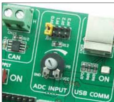
Рисунок 12-2: Вывод PF0 используется в качестве входного контакта для А / Ц преобразования
