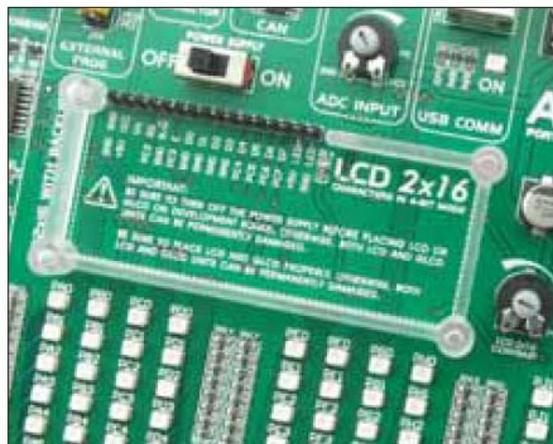
Рисунок 18-1: Разъем для буквенно-цифрового ЖК-дисплея
