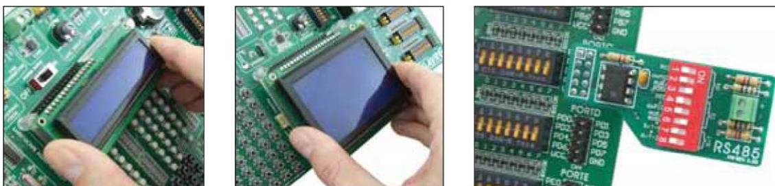
Рисунок 1-3: Размещение дополнительных модулей на плате
