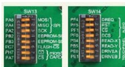
Рисунок 14-2: Включение линий связи аудио кодека
