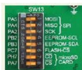
Чтобы получить доступ к MicroSD карте, необходимо включить линии связи **SPI**, используя **SW13.1 - SW13.3** DIP-переключатели, а также линии выбора микросхемы Chip Select (**CS**) и обнаружение карты Card Detect (**CD**), используя **SW13.7** и **SW13.8** переключатели.
