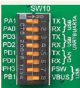
Вы можете обнаружить, является ли USB устройство подключено к разъему с помощью Vbus линии обнаружения питания (PB1).
