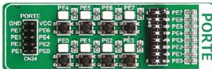
Рисунок 6-1: группа I/ O содержит выходной разъем порта, DIP-переключатель трех состояний, кнопки и светодиоды, расположенные все в одном месте
