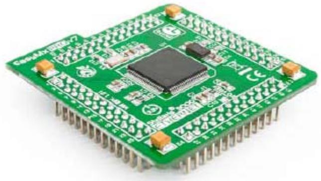
контроллер Ethernet с PHY, USB (OTG, Host, Device), до 65 общего назначения I / O выходы, 5 16-разрядных таймеров, 16 выводов Аналогового входа (AD), 3 UARTs, внутренние часы реального времени (RTC), пару: I2C, SPI и CAN контроллеров. Он также содержит 3 аналоговых компаратора, 16 цифровых компараторов.
