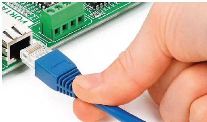
Особенностью платы является стандартный разъем **RJ-45**, который позволяет микроконтроллеру, что поддерживает связь Ethernet, установить соединение с компьютером, маршрутизатором или другими устройствами.
