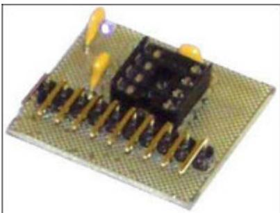
Плата предназначена для совместной работы с базовым блоком **NM9215** и соединяется с ним при помощи 10-ти контактного интерфейсного шлейфа. Адаптер предназначен для работы с микросхемами памяти серии 93C06, 93C46, 93C56, 93C66, 93C76, 93C86. NM9216/4. Размеры печатной платы 27x25 мм.
