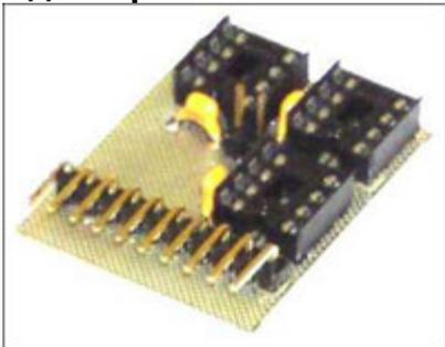
Плата предназначена для совместной работы с базовым блоком **NM9215** и соединяется с ним при помощи 10-ти контактного интерфейсного шлейфа. Адаптер предназначен для работы с микросхемами памяти серии 24C02, 24C04, 24C08, 24C16, 24C32, 24C64, 24C128, 24C256, 24C512, PCF858x, SDA2526, SDA2546, SDA2586. Размеры печатной платы 34x27 мм.
