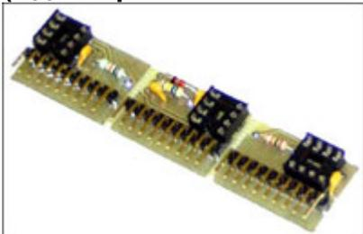
Плата предназначена для совместной работы с базовым блоком **NM9215** и соединяется с ним при помощи 10-ти контактного интерфейсного шлейфа. Адаптер предназначен для работы с микросхемами памяти серии SDE2560, NVM3060 и SPI 25xxx. Размеры печатной платы 82x20 мм.
