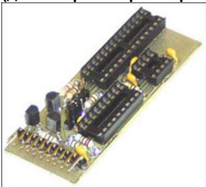
Плата предназначена для совместной работы с базовым блоком **NM9215** и соединяется с ним при помощи 10-ти контактного интерфейсного шлейфа. Адаптер предназначен для работы с микроконтроллерами фирмы Microchip следующих типов: PIC12C50x (**DD1**); PIC16Fxx (**DD2**), PIC16F87x (**DD3**). Размеры печатной платы 73x27 мм.
