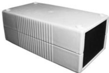
Разъемный корпус состоит из нижней и верхней части, в которых предусмотрена возможность крепления платы внутри корпуса посредством шурупов. Изготовлен из серого пластика. Две боковые съемные панели изготовлены из черного пластика и вставляются в пазы основных частей. Части крепятся шурупами.
