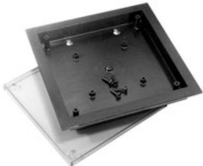
Корпус состоит из двух частей: нижняя часть, в которой предусмотрена возможность крепления платы внутри корпуса посредством шурупов, изготовлена из черного пластика; верхняя часть выполнена из прозрачного пластика. Части корпуса соединяются шурупами. Великолепно подходит для оформления электронных устройств со светодиодами и неоновыми лампочками.
