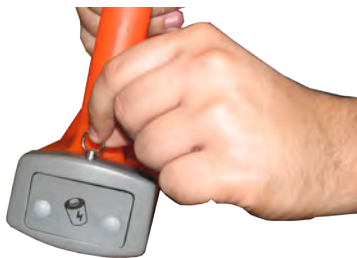
а) Выдвинуть фиксатор, освободить батарейный отсек
