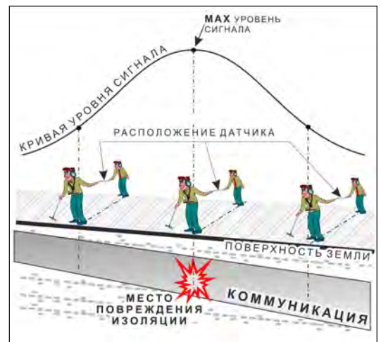
применение датчика-определителя дефектов коммуникации (ДОДК) методом max
