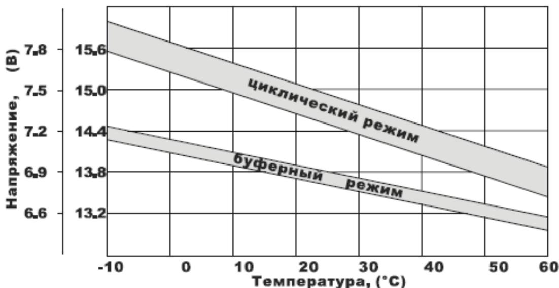
Рис 7. Зависимость зарядного напряжения от температуры окружающей среды.
