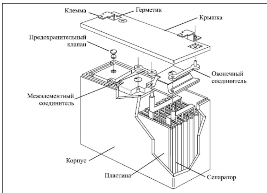
Рис 1. Конструкция моноблоков GENERAL SECURITY серии GSL
