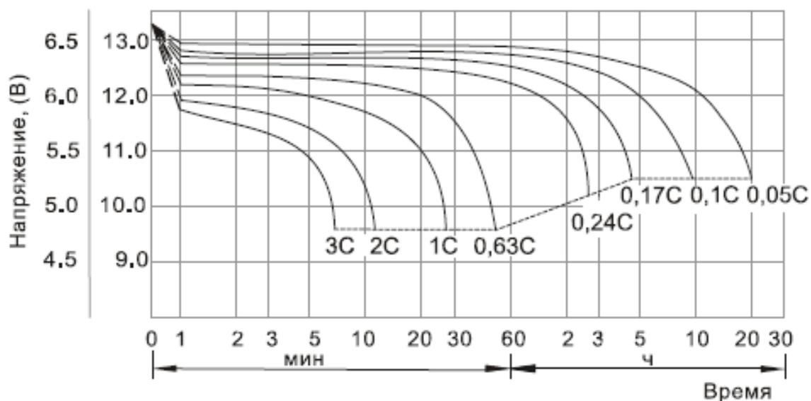
Рис 4. Разрядные кривые постоянным током при 25°C
