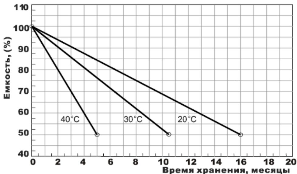
Рис 10. Зависимость емкости от времени хранения.
