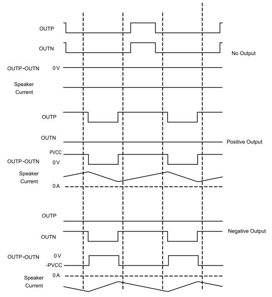
Figure 7-9. 1SPW Mode Modulation
