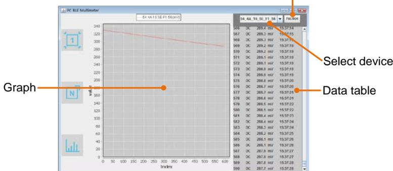
Операции в программном обеспечении MultimeterBLE
