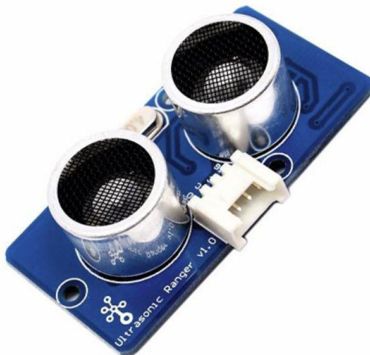
**Grove - Ultrasonic Ranger** - это бесконтактный модуль измерения расстояния, который работает на частоте 40 кГц. Когда вы подаете импульсный триггерный сигнал длительностью более чем 10микросекунд через штыревой вывод, Grove\_Ultrasonic\_Ranger будет выдавать 8 циклов с уровнем частоты 40 кГц и обнаруживать эхо. Импульсный сигнал эхосигнала пропорционален измеренному расстоянию. Вот формула:
