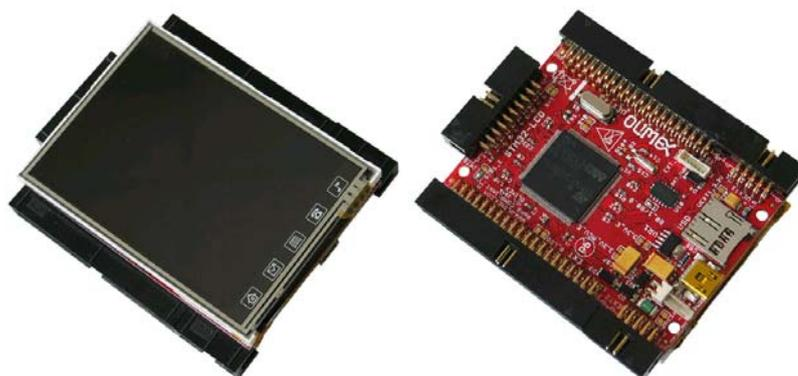
STM32-LCD – отладочная плата с STM32F103ZE микроконтроллером от STMicroelectronics. Этот мощный микроконтроллер поддерживает различные последовательные интерфейсы, такие как USB, USART, SPI. Кроме того, вы также найдете акселерометр, JTAG, TFT LCD, разъем для Mini SD / MMC карт, и контакты расширения, куда вы можете подключить ваши дополнительные схемы. Все это позволяет создавать разнообразие мощных приложений.
