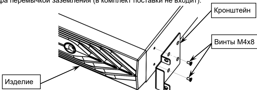
Рисунок 4 — Установка кронштейнов на корпус изделия.
