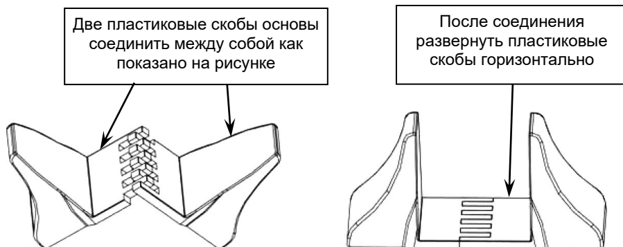
Рисунок 3 - Сборка пластиковых основ для вертикальной установки изделия.
