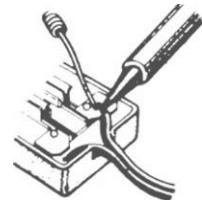
Подождите, пока припоя остынет и затвердеет, прежде чем двигать пропоенные части.
