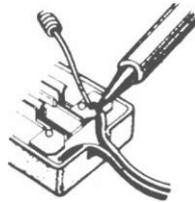
Подождите, пока припоя остынет и затвердеет, прежде чем двигать пропаянные части.
