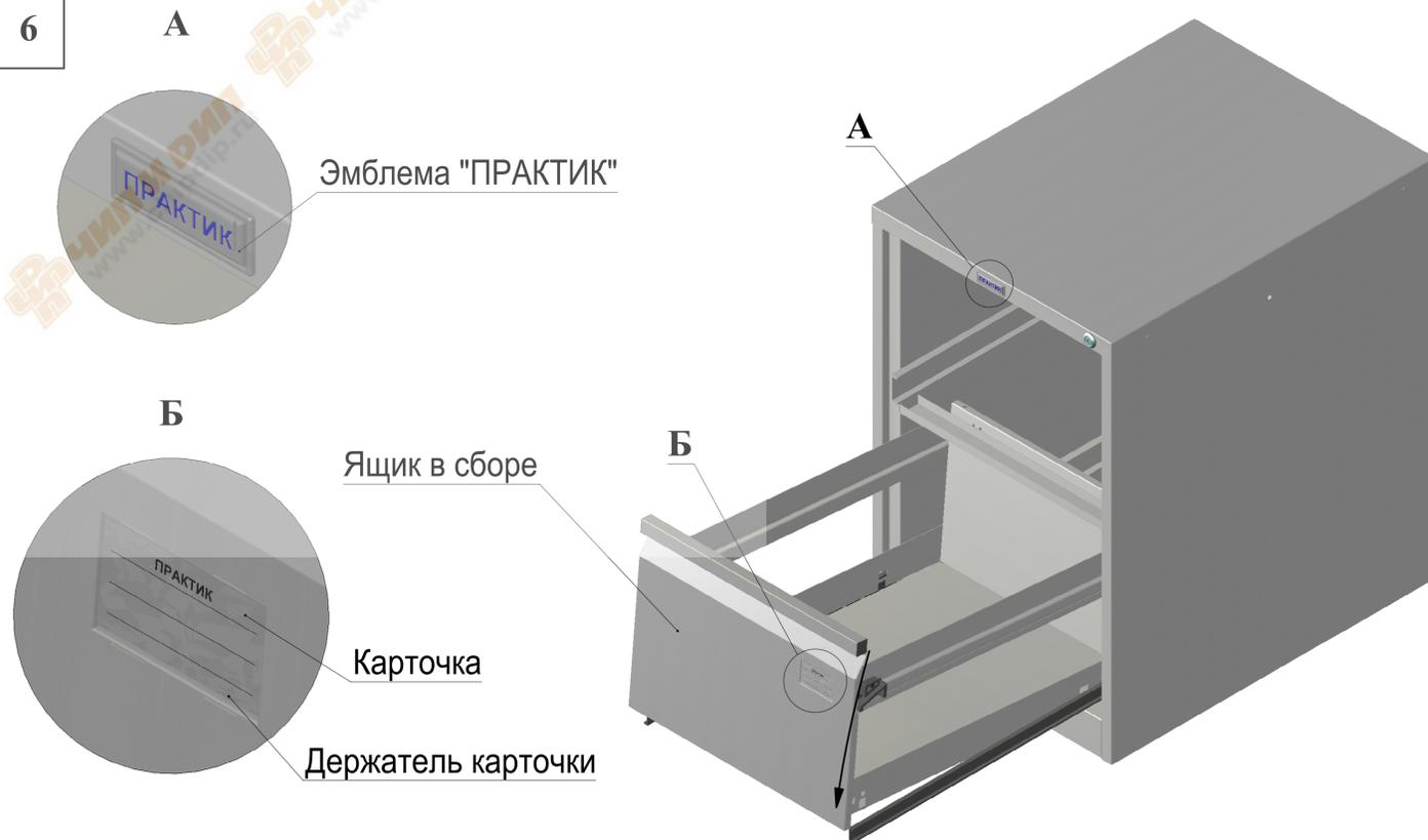
Установку ящиков в корпус картотеки необходимо производить, начиная с нижнего. Выдвинув несущую часть направляющей, совместить и завести в ее крепежные элементы пазы ящика. Повернув ключ замка картотеки по часовой стрелке и удерживая его, завести ящик наполовину в корпус, далее, отпустив ключ, задвинуть ящика до упора.
