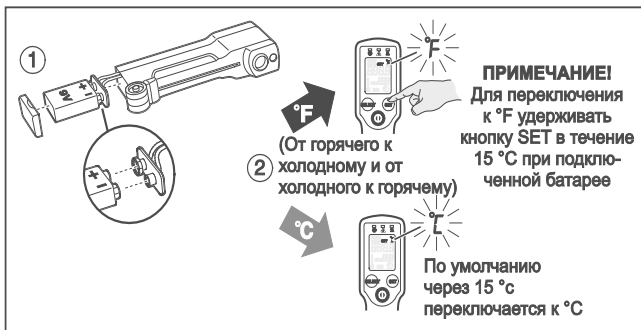
Рисунок 12. Установка/изменение шкал температуры °C и °F
