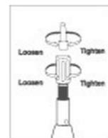
3. Выключите насадку припоя от соединения и вверните насадку горелки с соединением, ваше инструмент в настоящее время работает как мини-фонарик. (Рис. 6)
