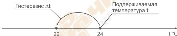
При этом нагреватель, управляемый терморегулятором, будет нагревать помещение до 24 °C и отключаться. После остывания помещения на 2 °C (до 22 °C), терморегулятор снова включит нагреватель и цикл повторится.
