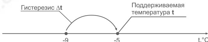
При этом охлаждающий элемент, управляемый терморегулятором, будет охлаждать морозильную камеру до -9 °C и отключаться. После повышения в ней температуры на 4 °C, т.е. до -5 °C, терморегулятор снова включит охлаждающий элемент, начнется охлаждение и цикл повторится.
