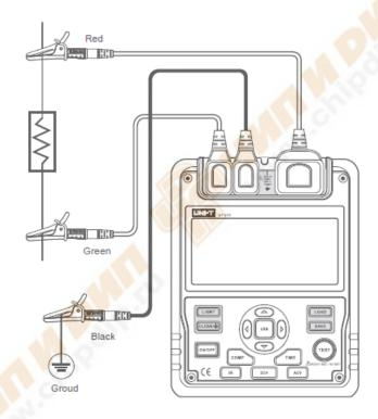
λ Не допускайте короткого замыкания щупов и цепи во время высокого выходного напряжения и сопротивления изоляции после испытания высокого выходного напряжения. Такая неправильная операция может вызвать искрение и пожар.
