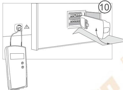
Сигнал можно назначать для основной и вторичной распределительной системы, с помощью предстановки передатчика "LEVEL I". Таким образом, можно узнать к какой цепи относятся предохранители и УЗО.
