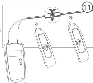
Учтите, что глубина обнаружения для защищенных кабелей и проводников отличается, так как концы кабеля скрученны друг с другом. Как правило, коротко замкнутую цепь можно обнаружить корректно, если сопротивление этой цепи ниже 20 Ohm. Измерить сопротивление можно с помощью мультиметра.
