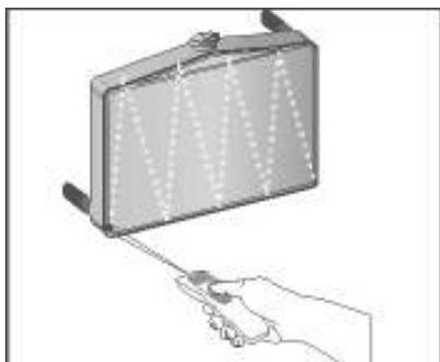
Для того, чтобы обнаружить область с повышенной температурой ("горячую точку"), направьте термометр за границы интересующей Вас зоны, затем измерьте температуру, передвигая прибор вверх и вниз до тех пор, пока Вы не найдёте горячую точку.
