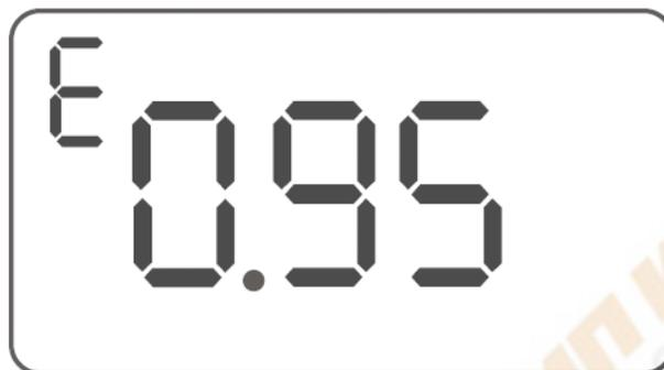
Для установки излучения вы должны пройти через функцию установки сигнализации. Как уже говорилось ранее, нажмите и удерживайте кнопку MODE, и на ЖК-дисплее отобразится функция установки сигнализации. Не отключайте прибор.
