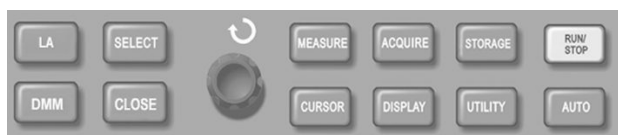
Рис. 2-21 Функциональная кнопка для системы выборки (дисплей)
