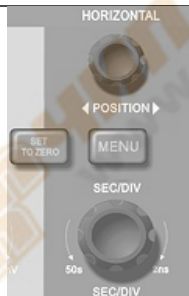
Рис. 2-11 Интерфейс управления горизонтальной системы
