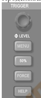
Рис. 1-11 Меню триггера на передней панели
