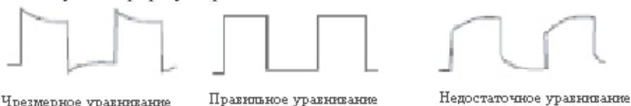
Рис. 1-8 Калибровка уравнивания щупа
