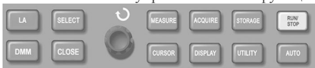
Рис. 2-27 Функциональная кнопка для системы выборки (курсор)
