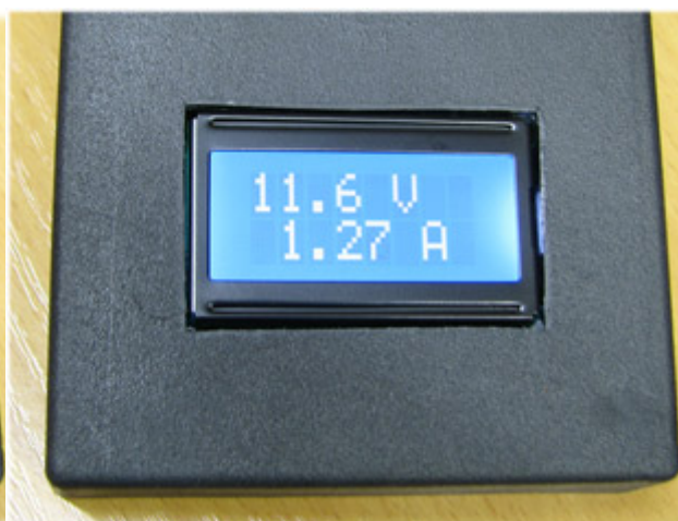
Фотография модуля SVAL0013, встроенного в корпус, до установки лицевой панели.
