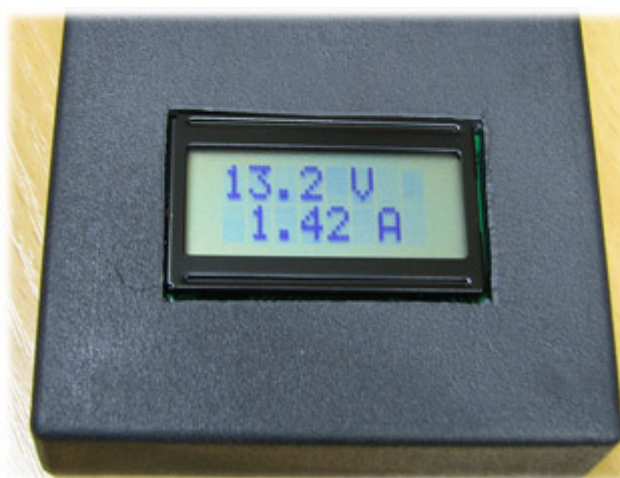
Фотография модуля SVAL0013, встроенного в корпус, до установки лицевой панели.
