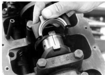
Сотрите полосу PLASTIGAUGE чистой промасленной ветошью. Остатки PLASTIGAUGE растворятся в смазке и не повредят двигателю. С помощью PLASTIGAUGE можно определить овальность вала подшипника, поместив полосу вдоль вала.
