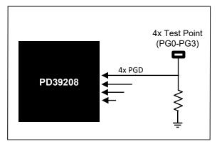
Figure 1-8. PGD0-PGD3 Test Points
