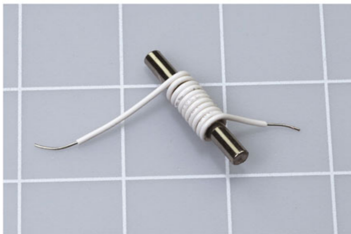
Рис. 5.21. Всего десяти витков провода может быть достаточно, чтобы создать небольшой электрический потенциал, когда через них проходит магнит
