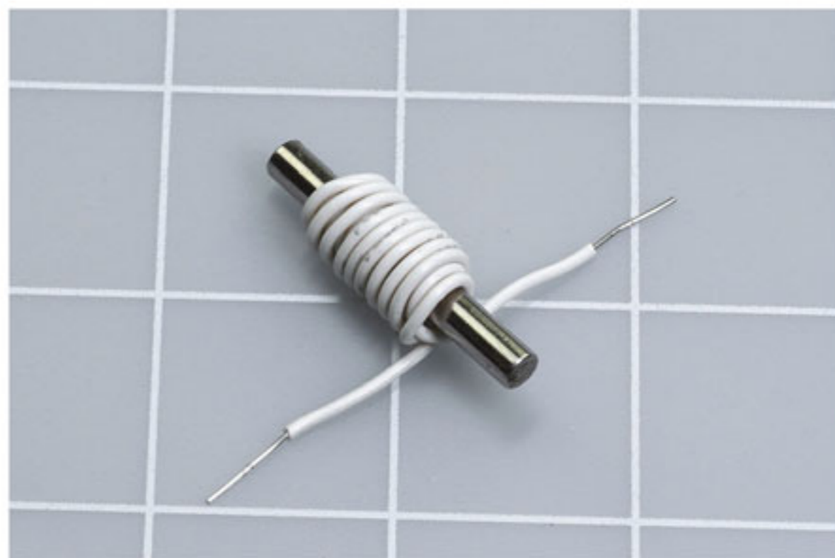
Рис. 5.22. Увеличение числа витков провода приводит к росту генерируемого напряжения
