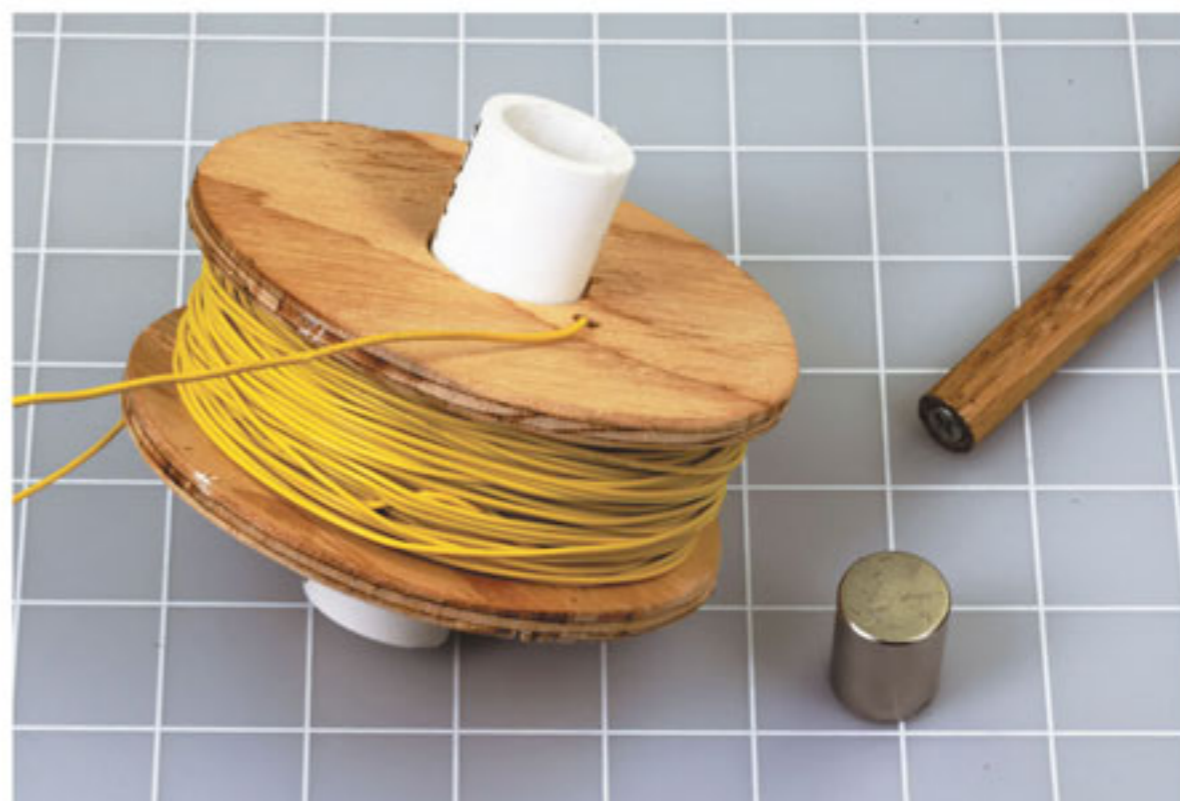
Рис. 5.23. Двести витков провода диаметром 0,64 мм на самодельной катушке с магнитом, который крепится к винту в дюбеле
