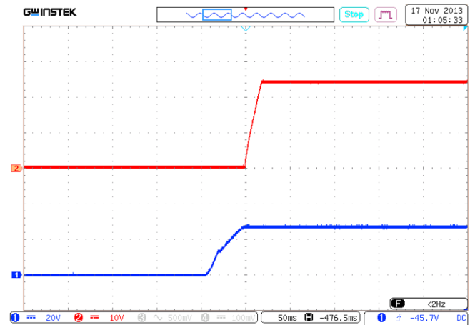
Рис. 9 (б). Осциллограмма установления выходного напряжения с момента подачи входного напряжения.
