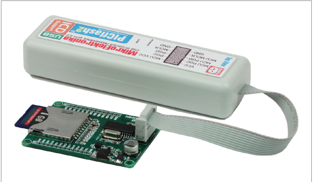
Рисунок 2: Дополнительная плата MMC ready подключена к программатору
