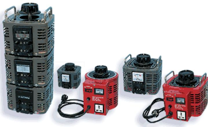
Специальные регулируемые автотрансформаторы: модель TDGC2 - однофазный и модель TSGC2 - трехфазный, в дальнейшем именуемые - "изделия", предназначены для плавного регулирования однофазного напряжения (модель TDGC2) и трехфазного напряжения (модель TSGC2) при питании от сети 220 или 380В соответственно, частотой 50 Гц, при использовании в качестве лабораторного автотрансформатора для наладки и тестирования различного электрооборудования.
