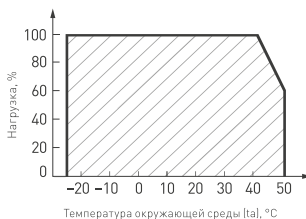
Рис. 5. Максимальная допустимая нагрузка, % от мощности источника
